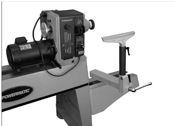
Figura 6-7: accesorios de torneado exterior
