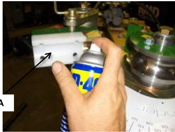
Lubricating counter die bending
